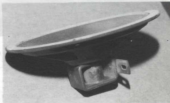
figura 10 - Altoparlante a bobina mobile con magnete permanente, degli anni '50.
