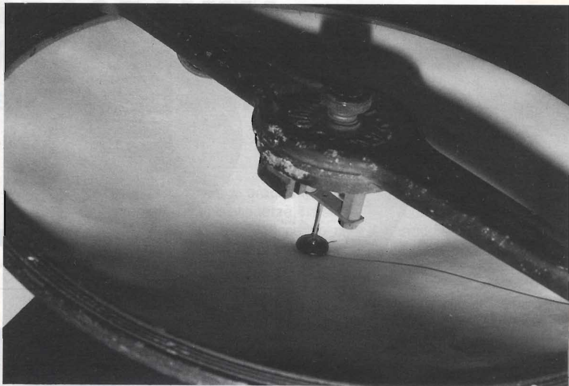
figura 5 - Particolare dell'altoparlante di figura 4 in cui è visibile parte della lamella vibrante e l'asticina di collegamento al cono.
