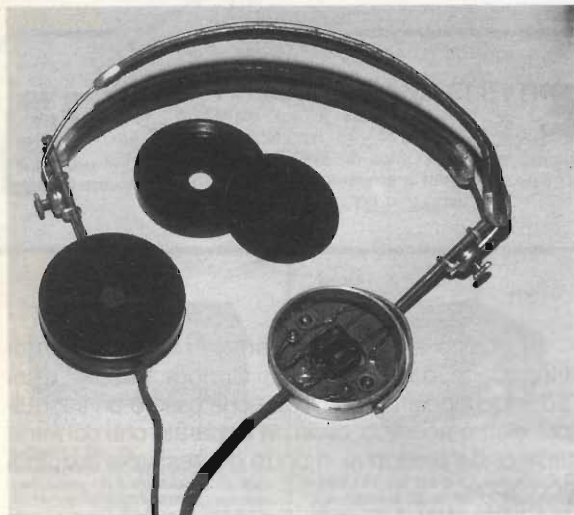
figura 2 - Cuffia telefonica del 1932. Nell'auricolare scoperto sono visibili le due espansioni polari del magnete permanente e la bobina L.
